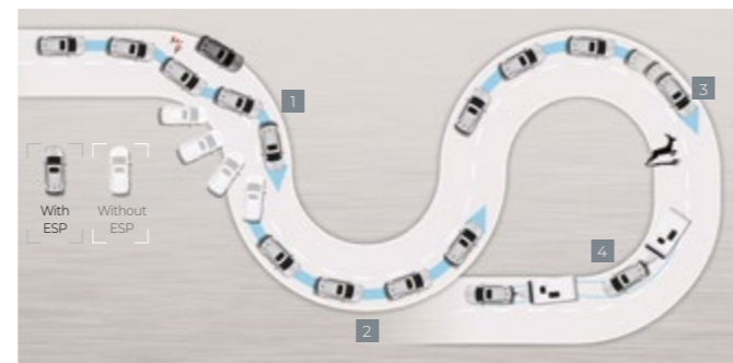
1. ESP - system dynamicznej kontroli toru jazdy 2. ARP - system aktywnej ochrony przed dachowaniem 3. BAS - system wspomagania hamowania awaryjnego 4. Kontrola kołysania przyczei - stabilizuje odchylenia i kołysanie ciągniętej przyczei
