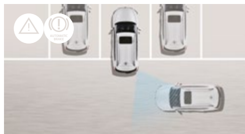
RCTA - Radar ruchu poprzecznego z tyłu pojazdu
